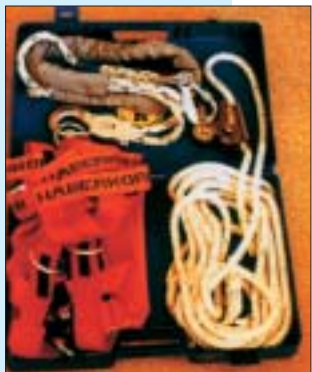
Sicherheitskoffer für Dacharbeiten mit Sicherheitsgeschirr, Falldämpfer und Seilkürzer (Sturzfänger)
