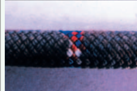
Abb. 14: Ausbleichen des Mantelgewebes; an der bunten Stelle war das Seil im Freien aufgehängt
