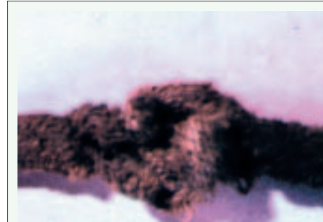
Abb. 5: Krangelbildung bei einem alten, ver- schmutzten Seil
