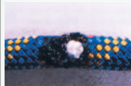
Abb. 13: Anschmelzstelle bei einem Kern-Mantel- Seil
