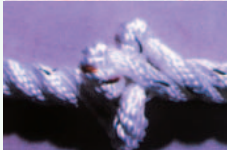
Abb. 4: Krangelbildung bei einem neuen Seil
