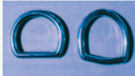
Abb. 18: Verformte Halteöse (rechts) nach Sturz- belastung oder miss- bräuchlicher Verwen- dung
