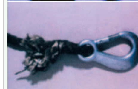
Abb. 8: Gelockerter Spleiß und fehlende Karabinersicherung
